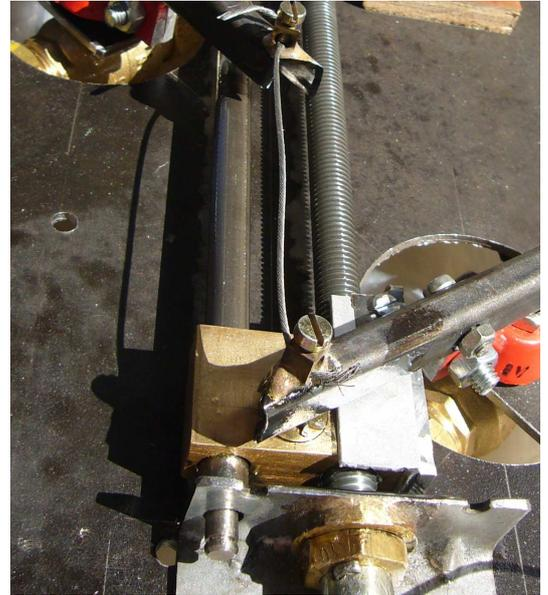
Rôle du câble : lorsque le pion d'entraînement arrive en position « milieu », il lâche la poignée de vanne en position fermée, mais la poignée n'est pas tout à fait à 90° de l'axe du corps de vanne.. En fin de course, le câble se tend, la fermeture est optimisée.
